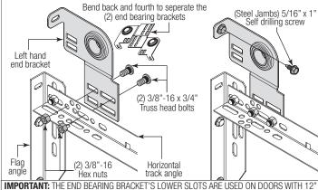
RADIUS TRACK; THE UPPER SLOTS ARE USED ON DOORS WITH 15" RADIUS TRACK.
