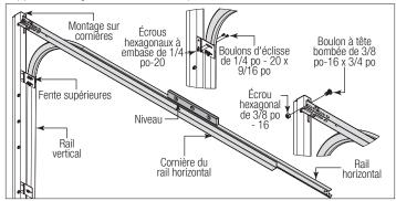
Mettez ensuite l'assemblage de rail horizontal de niveau et fixez la cornière du rail horizontal sur la première fente de la cornière/du montage sur cornières à l'aide de 1 boulon à tête bombée de 3/8 po - 16 x 3/4 po et de 1 écrou hexagonal de 3/8 po - 16. Répétez la procédure pour l'autre côté. Retirez le clou qui maintenait temporairement la section du haut en place.
