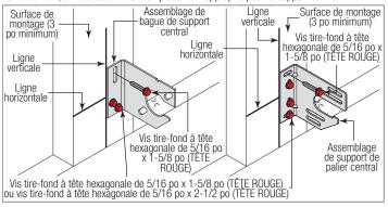
SI VOTRE PORTE EST FOURNIE AVEC UN ASSEMBLAGE DE COUPLEUR CENTRAL OU DES RESSORTS DE TORSION D'UN DIAMÈTRE INTÉRIEUR DE 3,75 PO°: tracez une ligne verticale au crayon sur la surface de montage au-dessus de la porte, au centre. Divisez la différence et placez les 2 supports de paliers centraux loin l'un de l'autre. Tracez deux lignes verticales au crayon, une pour chaque support de palier central sur la surface de montage au-dessus de la porte.
