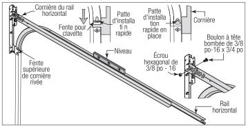
**POUR LES AUTRES CORNIÈRES DRAPEAU:** Pour installer le rail horizontal, placez l'extrémité recourbée sur la piste de roulement du rail supérieur de la section du haut. Alignez le bas du rail horizontal sur le haut du rail vertical. Serrez le rail horizontal sur la cornière drapeau avec (2) boulons d'éclisse de 1/4 po - 20 x 9/16 po et (2) écrous hexagonaux à embase de 1/4 po - 20.
