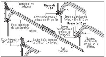
SI VOUS AVEZ UN DISPOSITIF DE MONTAGE SUR CORNIÈRE: Pour installer le rail horizontal, placez l'extrémité recourbée sur la piste de roulement du rail supérieur de la section du haut. Alignez le bas du rail horizontal sur le haut du rail vertical. Serrez le rail horizontal sur le dispositif de montage sur cornière evec (2) boulons d'éclisse de 1/4 po - 20 x 9/16 po et (2) écrous hexagonaux à embase de 1/4 po - 20.
