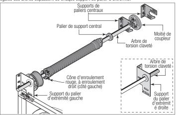
REMARQUE: Positionnez les deux arbres de torsion clavetés de manière à ce que des longueurs égales des arbres dépassent de chaque support de palier d'extrémité.
