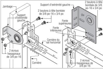
IMPORTANT°: LES FENTES INFÉRIEURES DES SUPPORTS DE PALIERS D'EXTRÉMITÉS SONT UTILISÉES SUR LES PORTES AVEC DES RAILS AVEC UN RAYON DE 12 POUCES; LES FENTES SUPÉRIEURES S'UTILISENT SUR LES PORTES AVEC DES RAILS AVEC UN RAYON DE 15 POUCES.
