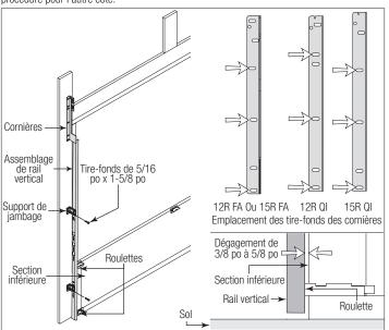
**POUR L'ASSEMBLAGE DE RAIL VERTICAL RIVɰ:** fixez, sans serrer, les supports de jambage et la cornière sur le jambage avec des tire-fonds de 5/16 po x 1-5/8 po. Serrez les tire-fonds en fixant le support de jambage inférieur sur le jambage et en conservant un dégagement de 3/8 po à 5/8 po comme indiqué entre la section inférieure et le rail vertical. Faites pendre le câble de levage de contrebalancement au-dessus de la cornière. Répétez la
