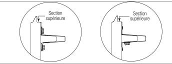
SI VOTRE PORTE EST VENUE AVEC UN AMORTISSEUR (ASYMÉTRIQUE): Placez l'amortisseur asymétrique sur la nervure de la section supérieure de la porte, comme illustré. Fixez chaque extrémité de l'amortisseur asymétrique sur le capuchon avec 2 vis autoperceuses de 1/4 po - 20 x 11/16 po. Fixez le centre de l'amortisseur asymétrique comme
