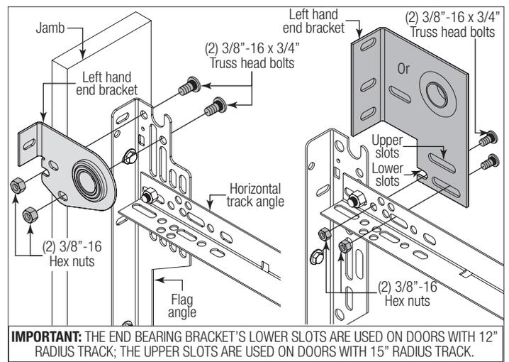
**IMPORTANT:** THE END BEARING BRACKET'S LOWER SLOTS ARE USED ON DOORS WITH 12" RADIUS TRACK; THE UPPER SLOTS ARE USED ON DOORS WITH 15" RADIUS TRACK.
