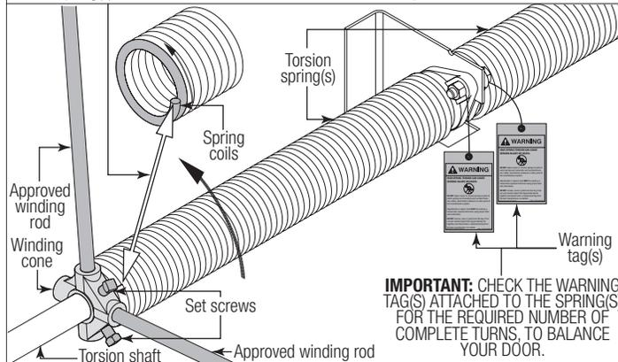
**IMPORTANT:** CHECK THE WARNING TAG(S) ATTACHED TO THE SPRING(S) FOR THE REQUIRED NUMBER OF COMPLETE TURNS, TO BALANCE YOUR DOOR.
